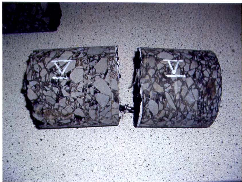
Bild5: Bohrkerne mit S&P Carbophalt - Einlage, abgesichert (BK 5)
