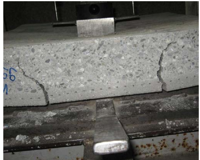
Bild 8: Prüfling VSH im Bruchzustand
