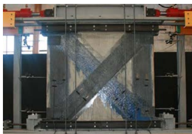
Bilder 21 / 22 / 23: Unterschiedliche Anordnung der S&P C-Sheet 240
