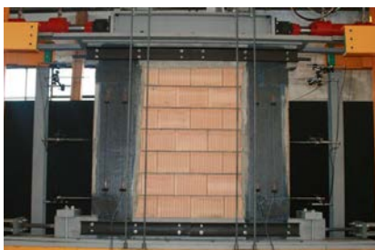
Bilder 21 / 22 / 23: Unterschiedliche Anordnung der S&P C-Sheet 240
