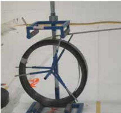
1 Ablängen der Lamellen mit Hilfe des Abrollbocks
