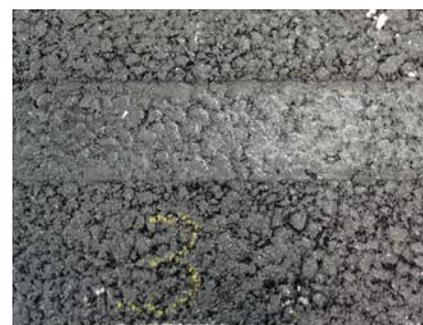
Asphaltplatten mit Faserrückständen nach Spurrinentest
