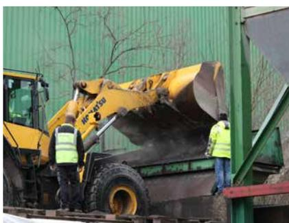
Zugabe des Fräsgutes in die Mischanlage
