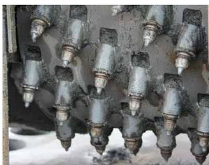
Fräskopf nach dem Fräsen von S&P Armierung
